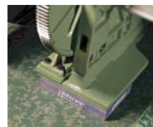
Виброизолирующий элемент под опорой ткацкого станка
